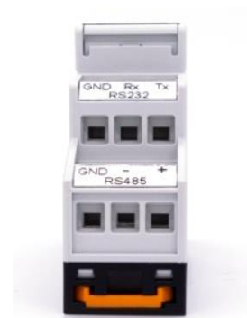
Fig. 2 Collegamento seriale RS485 ←
