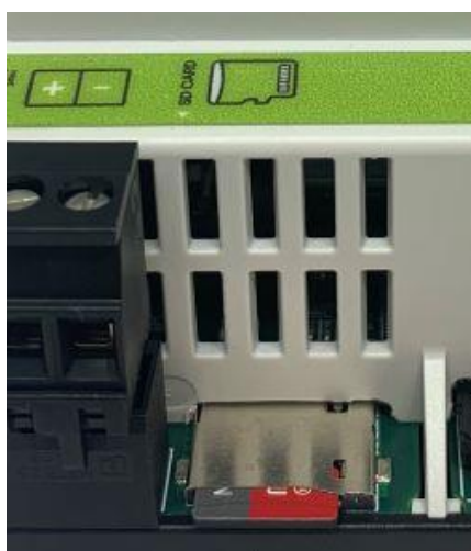
Fig.1 Inserimento SD Card
