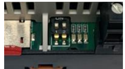
Fig.6 Esempio posizione DIP: OFF OFF ←
